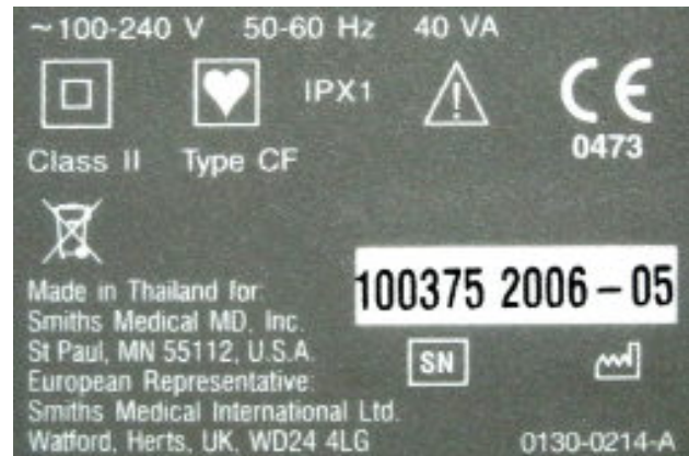
Hình 5. Ví dụ về thiết bị Class II, bộ phận ứng dụng Type CF
