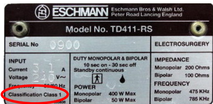
Hình 4. Ví dụ về kí hiệu Class 1 của thiết bị Dao mổ điện
